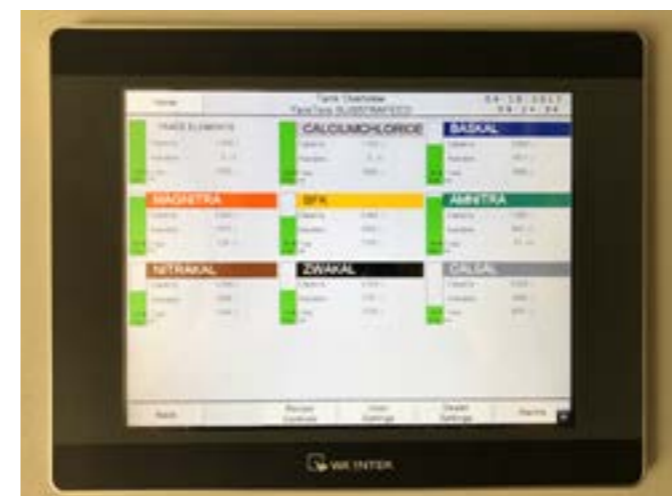
Met slechts één druk op de knop de A+B bakken vullen en altijd op de hoogte van uw actuele voorraad meststoffen - digitaal en ook analoog.
